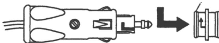
Ohne rote Ausgleichshülse mit Bajonettverschluss Verwendung in der Normalsteckdose.
